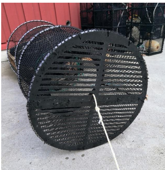
Figur 5: Ruser og seleksjonsrister brukt i kontrollerte felteksperimenter i ruse for å sammenlikne utsortering av undermåls bergnebb og grønnfylt. Her vises leppefiskruse med heldekkende enderist satt inn i siste ring. Ruseposen er vrent oppover på utsiden av rusen.
