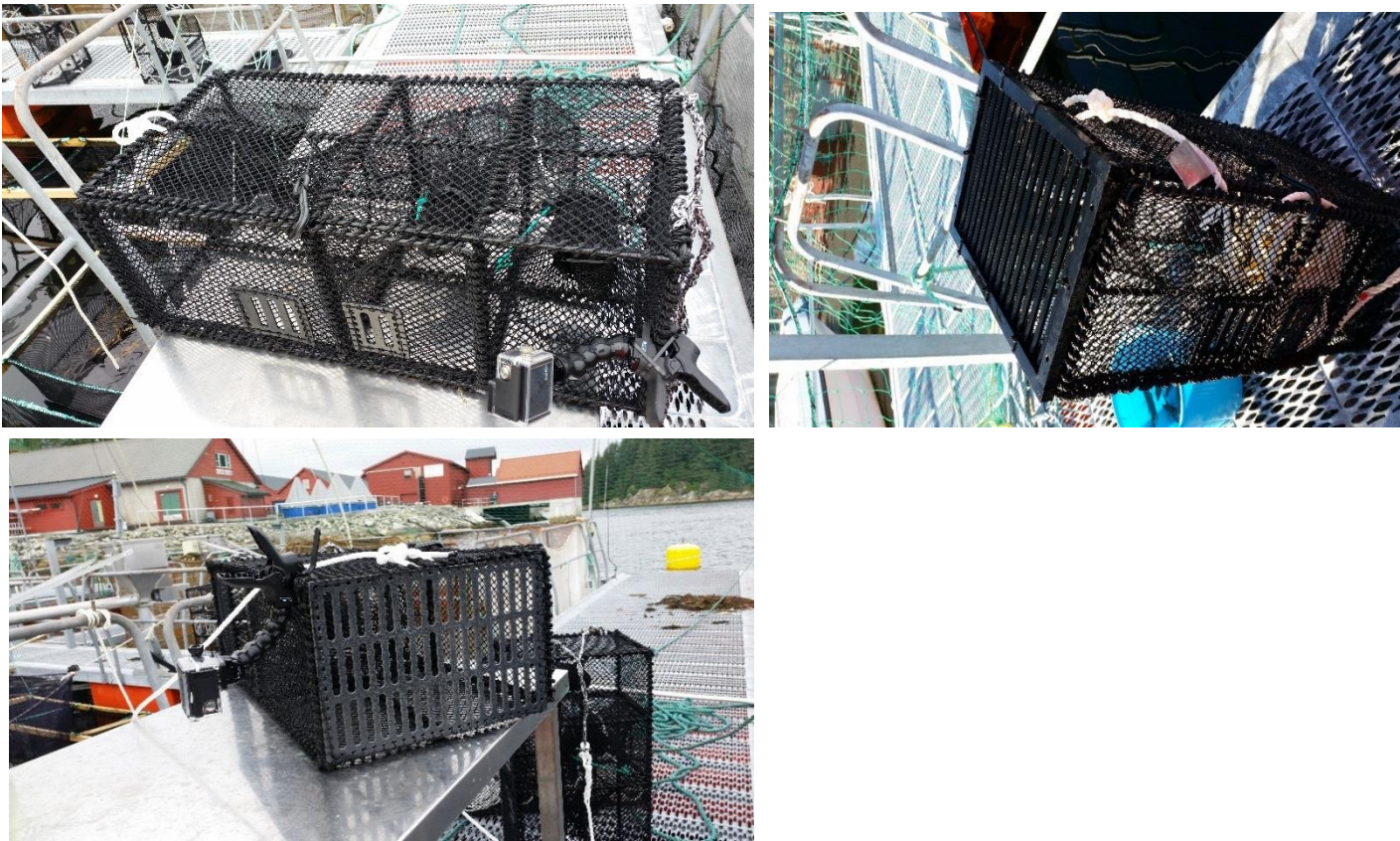
Figur 2. De ulike risttypene brukt i det kontrollerte merdforsøket med seleksjonsristeksperimenter i teine for å sammenlikne utsortering av undermåls bergnebb og grønnfylt. Øverst til venstre: standard 3-spalters siderist; nederst til venstre: heldekkende enderist med flate spiler; til høyre: heldekkende enderist med runde spiler. For flate spiler ble både 11 og 12 mm rist testet.
